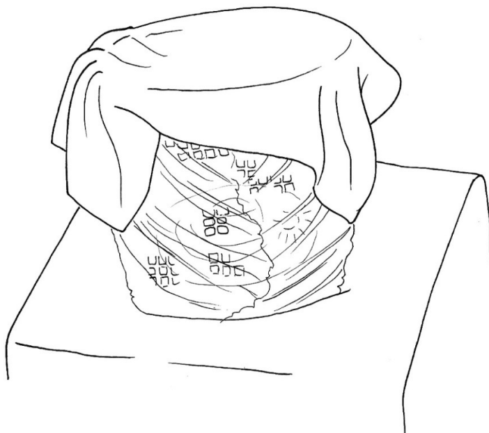
fig. 5.1. Novamente, quando o conjunto do sino estiver montado, ele terá 16 polegadas de altura e 16 polegadas de diâmetro. Há uma sobreposição de 2 polegadas, portanto, amarre todo o comprimento dela com barbante! Nesta ilustração, a toalha é apenas uma simples toalha de cozinha.
