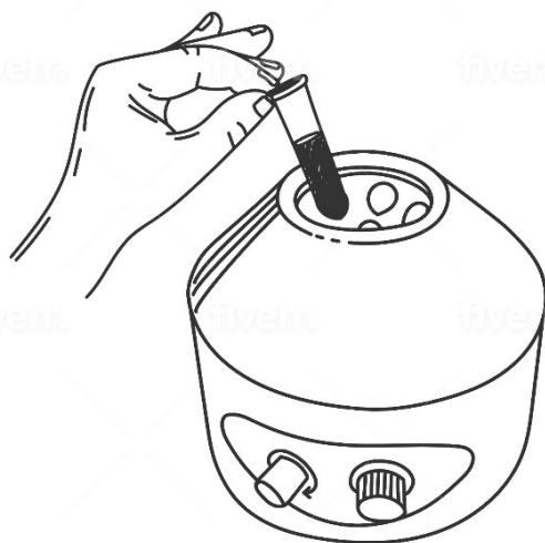
fig. 6.3. Ao manusear o tubo de centrífuga, tente não perturbar nenhum dos sólidos no fundo. Em resumo, ele deve ser transferido "gentilmente" para o recipiente receptor. Geralmente, tenho um pequeno pote de frutas com tampa por perto. Ao tentar remover os líquidos de cada tubo de centrífuga, incline o tubo de centrífuga bem devagar para que os líquidos saiam lentamente. Deixe que todos os líquidos entrem em uma jarra de frutas limpa [com um filtro de café conectado por um elástico] sem perturbar nenhum dos "sólidos presos" no fundo do tubo em questão.
