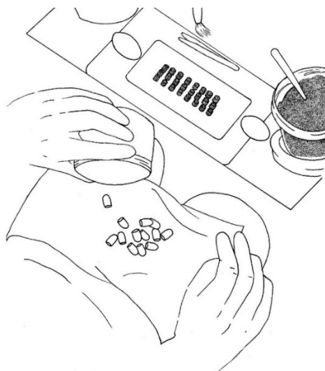
fig. 3.13: A conclusão do processo de encapsulamento termina aqui. A última etapa é coletar, limpar e engarrafar todas as cápsulas prontas. Isto aqui eu uso a caneta Bic. Viro o quadro de comprimidos e coloco as cápsulas na toalha subjacente após a montagem colo.
